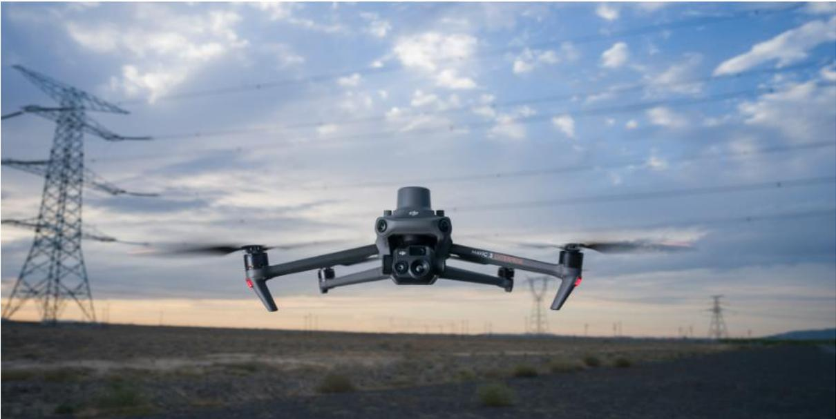
Diseñado para servir a las necesidades especiales de las operaciones aéreas en la lucha contra incendios, búsqueda y rescate, inspecciones y misiones nocturnas, el DJI Mavic 3T tiene una cámara de 48 MP con un sensor CMOS de 1/2", así como una cámara térmica con un campo de visión (DFOV) de 61° y una distancia focal equivalente de 40mm con una resolución de 640 x 512 px.
