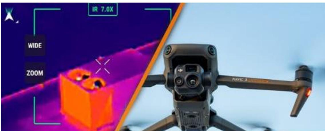
Con un alcance de control máximo de 15 km, la transmisión DJI O3 Enterprise permite a los drones Mavic 3 Enterprise volar más lejos y transmitir señales con mayor estabilidad, ofreciendo a los pilotos una mayor tranquilidad durante el vuelo. Proporciona una transmisión en directo de alta velocidad de fotogramas a 1080p/30fps. La distancia de transmisión es un indicador de la intensidad de la señal.
