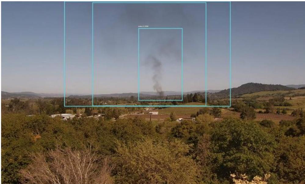
Figura 45: detección de columnas de humo usando el sistema Pano
