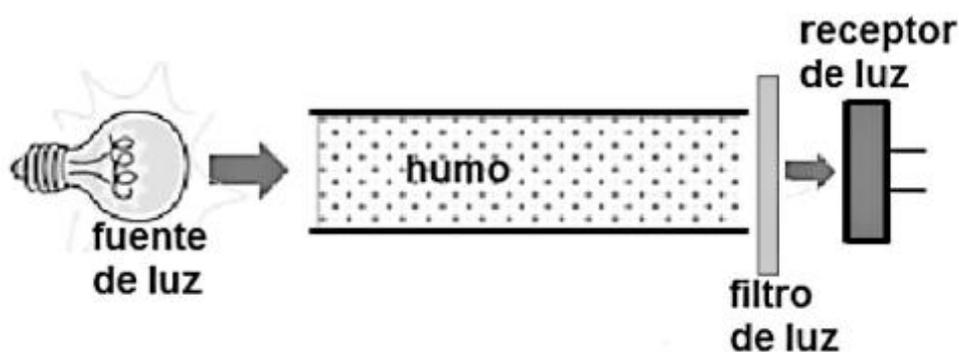
Figura 46: detección fotoeléctrica de humo
