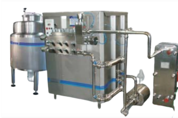
Figura N°14: Mezclador centrífugo directo, módulo de homogenizado y pasteurizador (Fuente: SIMES)
