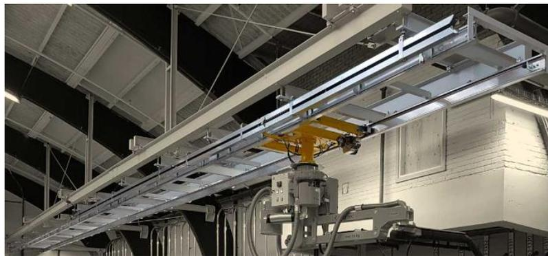
Ilustración 76 – Sistema de correderas del Manipulador. Fuente: DALMEC
