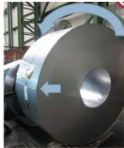
Rollos de material con flechas indicando la dirección de alimentación y el sentido de giro
