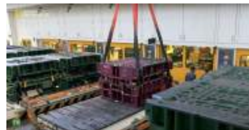
Se traslada mediante una base automatizada el troquel a la prensa correspondiente.
