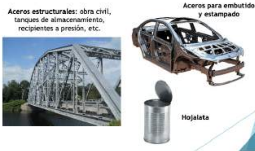
Aplicaciones de aceros bajos en carbono.
