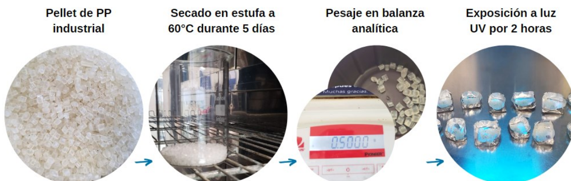
Figura 4. Acondicionamiento del pellet de PP previo al armado de los sistemas.
