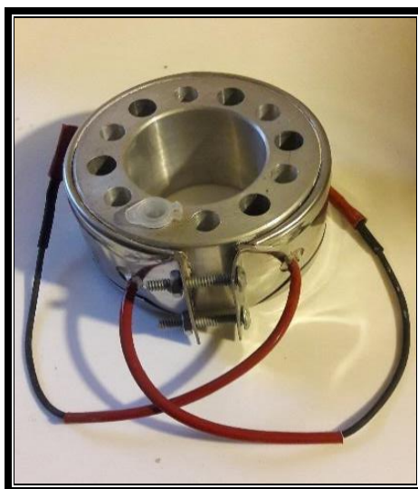
Figura 16: Primer prototipo de soporte de tubos con la resistencia calefactora.
