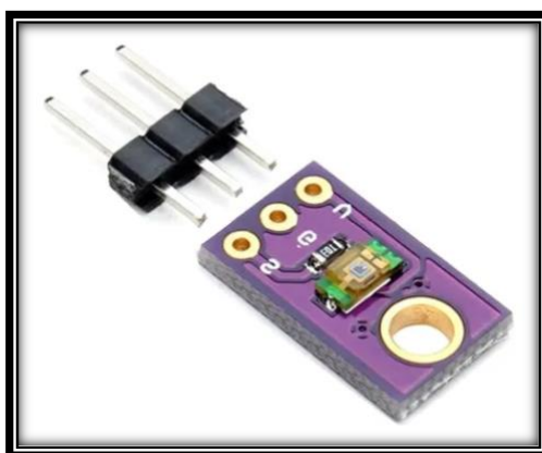
Figura 8: Sensor de luz ambiental TEMA6000. con rango de detección de 360 a 790 nm con pico en los 570nm.
