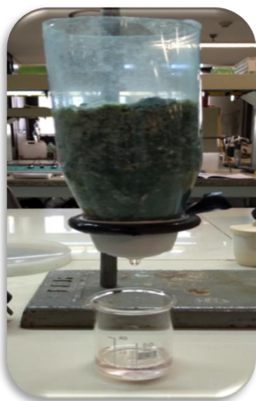
Figura 29.1. Pila de lixiviación con el desecho de matas de cobre vertiendo la solución lixivante sobre el vaso de precipitado
