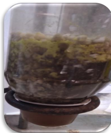
Figura 28.2. Pila con el mineral Los Viscos. En la parte superior del mineral mezclado con la perlita se observa el azufre molido
