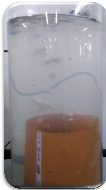
Figura 16.2. Reactor Airlift a los 10 días de su funcionamiento. Durante el crecimiento de las bacterias se observa que el medio de cultivo toma un color blanquecino
