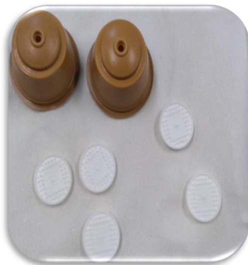
Figura 27.1. Cápsulas de café y filtros lavados utilizados para formar los soportes de las pilas
