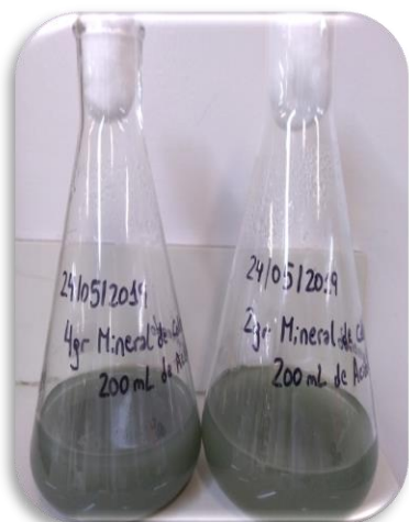
Figura 23.1. Tratamiento con 2 % de mineral (izquierda) y con 1 % del mineral (derecha), ambos con ácido biogenerado
