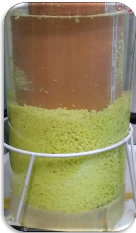
Figura 16.1. Reactor Airlift en el inicio de su puesta en marcha (Medio de cultivo OK de color transparente)
