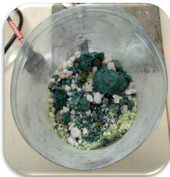
Figura 29.2. Pila de lixiviación con el desecho de matas de cobre (vista superior)
