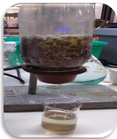
Figura 28.1. Pila con el mineral Los Viscos y solución lixiviada en el vaso de precipitado
