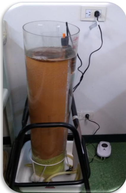
Figura 15.1. Reactor Airlift con burbujeo de aire esterilizado utilizado para obtener ácido biogenerado
