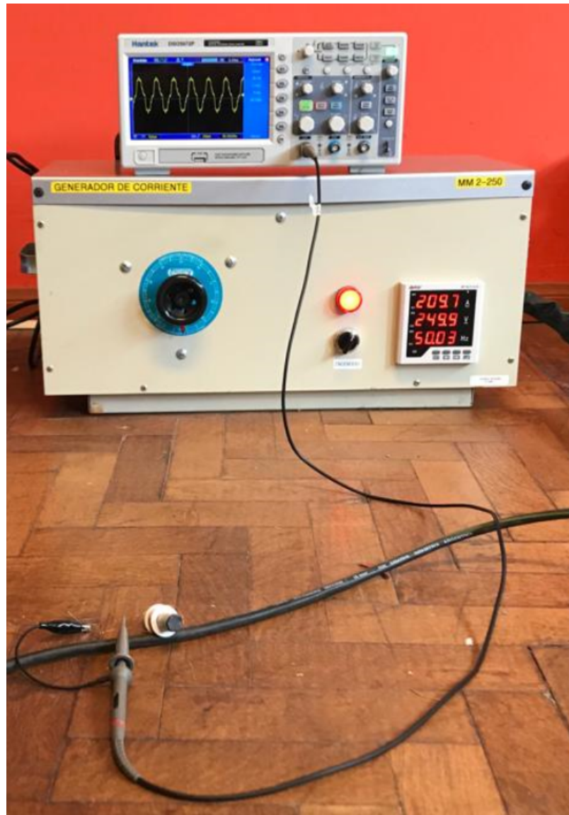
Imagen XXII: conexión para pruebas de medición de corriente de sensor inductivo
