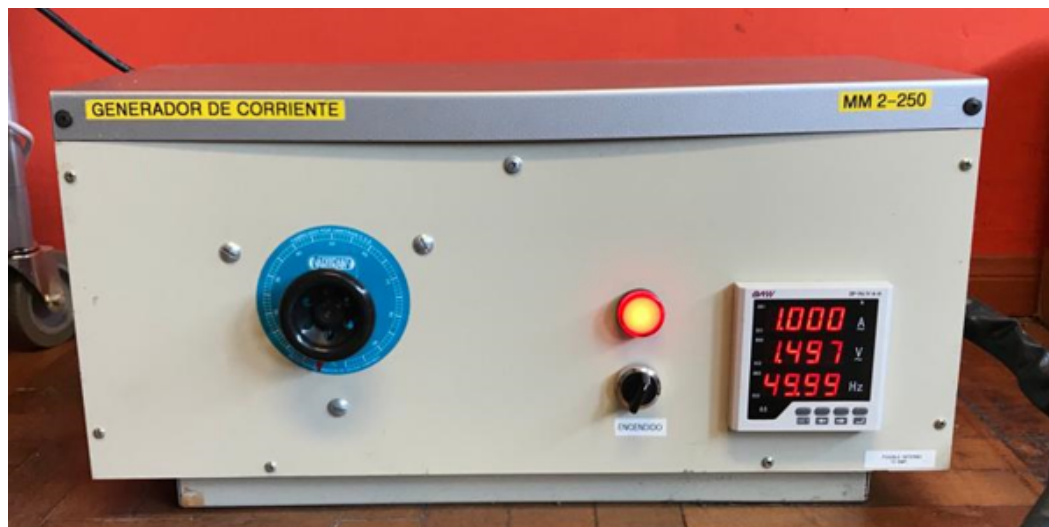
Imagen XIX: generador de corriente alterna 250A-50Hz
