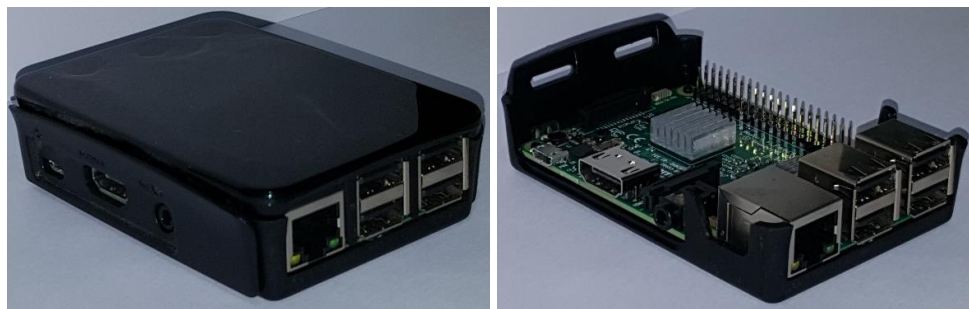
Figura 19. Dispositivo Raspberry Pi 3 Model B+ montado dentro de una carcasa (Fuente: Fotografía propia).
