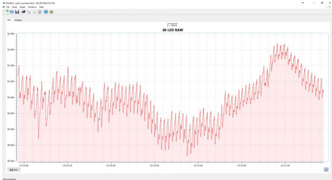
Ilustración 11: Lectura del sensor MAX30102 en el tiempo Fuente: https://morf.lv/implementing-pulse-oximeter-using-max30100
