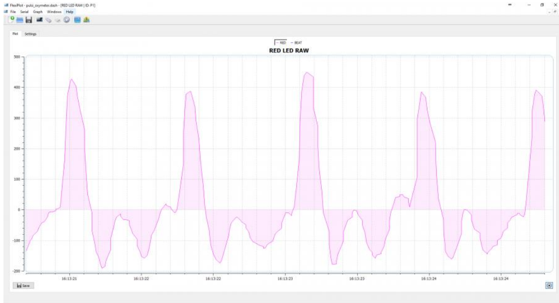
Ilustración 13: Lectura filtrada del sensor MAX30102 en el tiempo Fuente: https://morf.lv/implementing-pulse-oximeter-using-max30100
