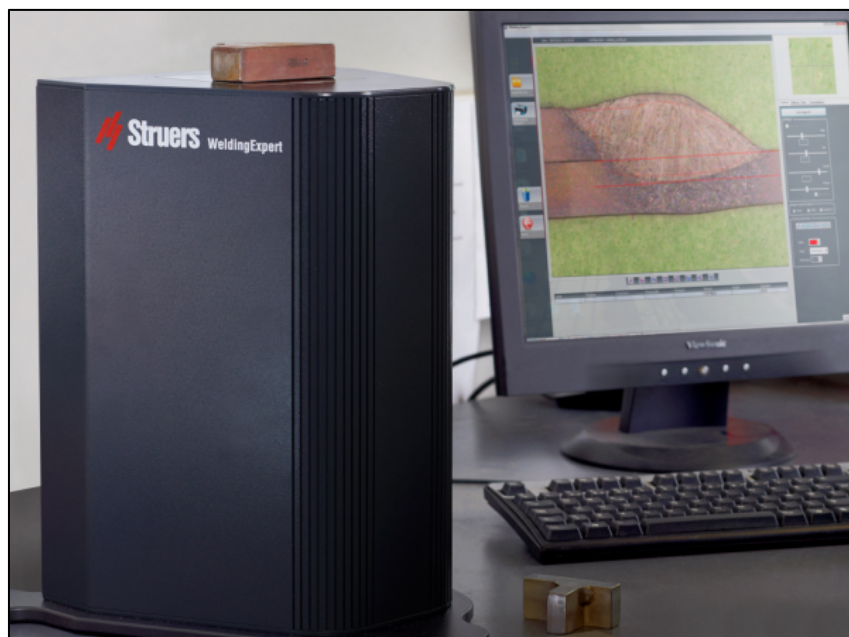
Figura 4-16: Medición de soldadura con equipo óptico digital (struers.com)
