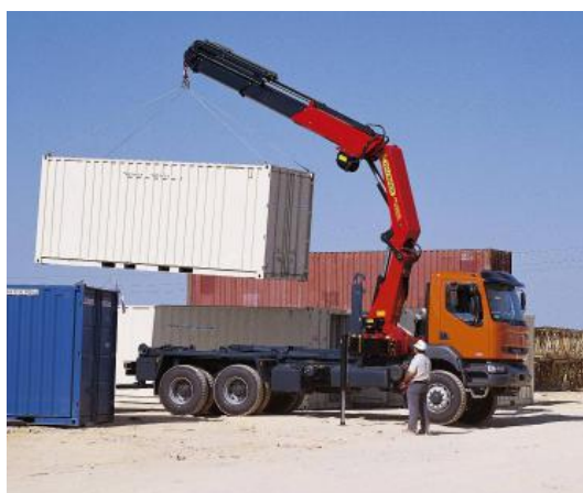
Camión con pluma. Fuente: Gruas Palotte. Recuperado de: https://gruaspalotte.cl/tag/izaje-2/
