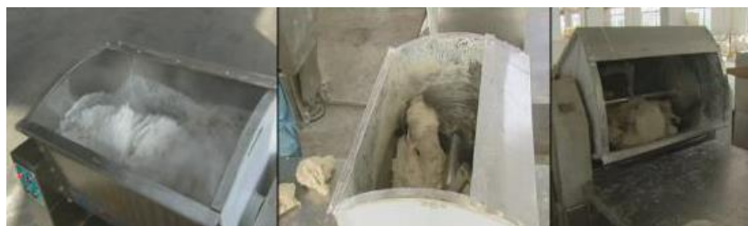
Ilustración 4 - Máquina mezcladora y amasadora en funcionamiento. Fuente: Jinan Arrow Machinery Co., Ltd.
