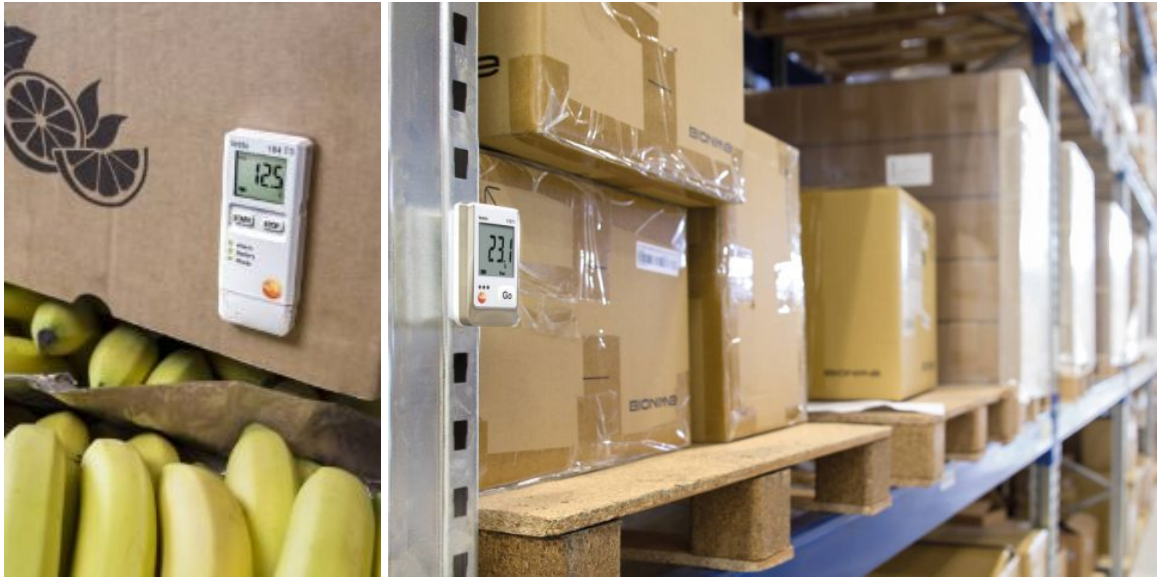
Figura 12: data logger aplicado en almacenamiento de mercaderías
