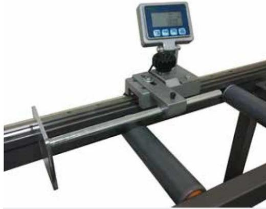
Figura 34 - Banco de medición digital. Fuente: Catalogo de CortaRapid
