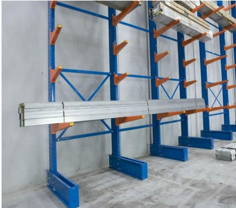
Figura 48 - Stock de tubos y ejes sobre estructura amurada a pared. Fuente:
