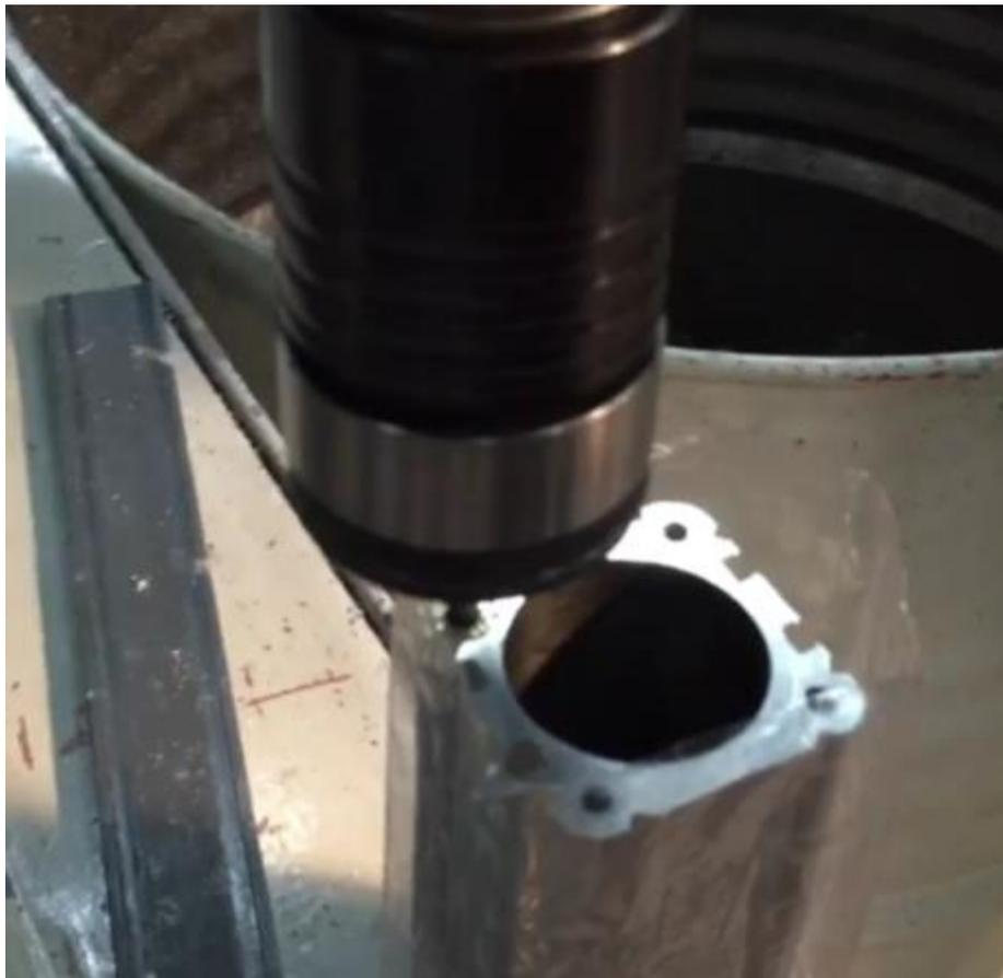
Figura 28 - Roscado de tubos de aluminio perfilado - Fuente: Elaboración propia
