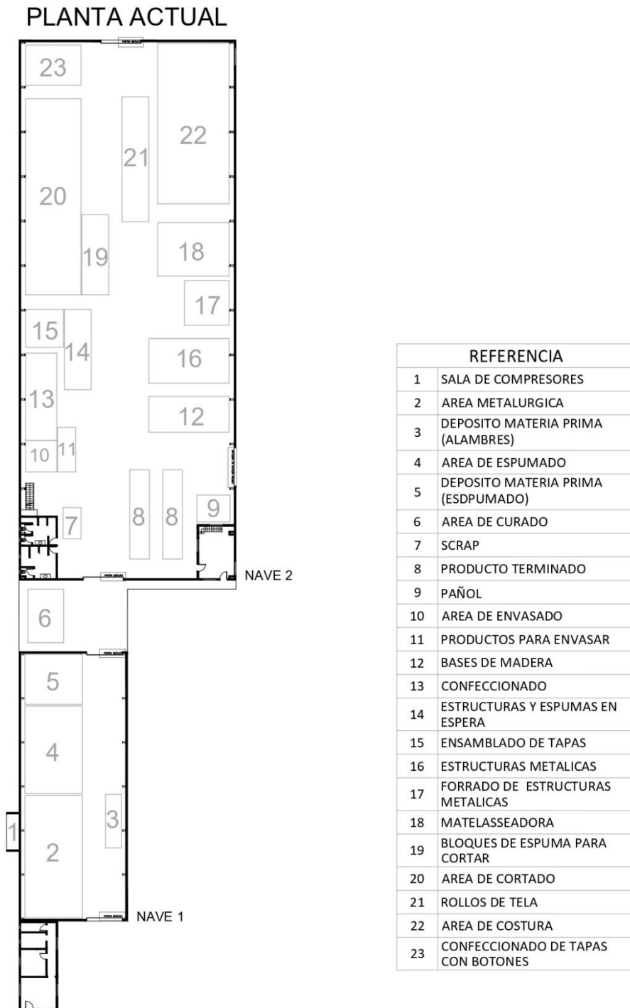
Figura 29: Vista de Planta Actual.
