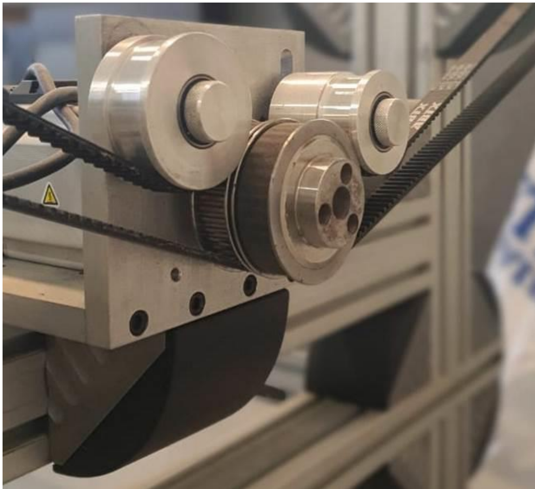
Fig. 9: Sistema de tensado y comando de correas para eje Y
