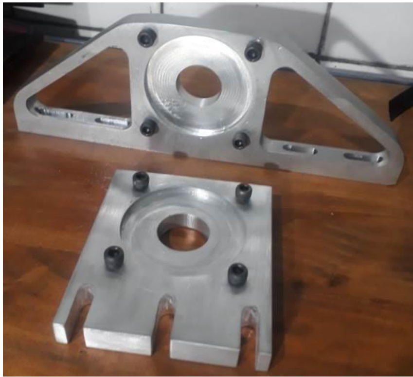
Fig. 5: Placas de sujeción de motores de aluminio 6061 T6 mecanizadas por CNC
