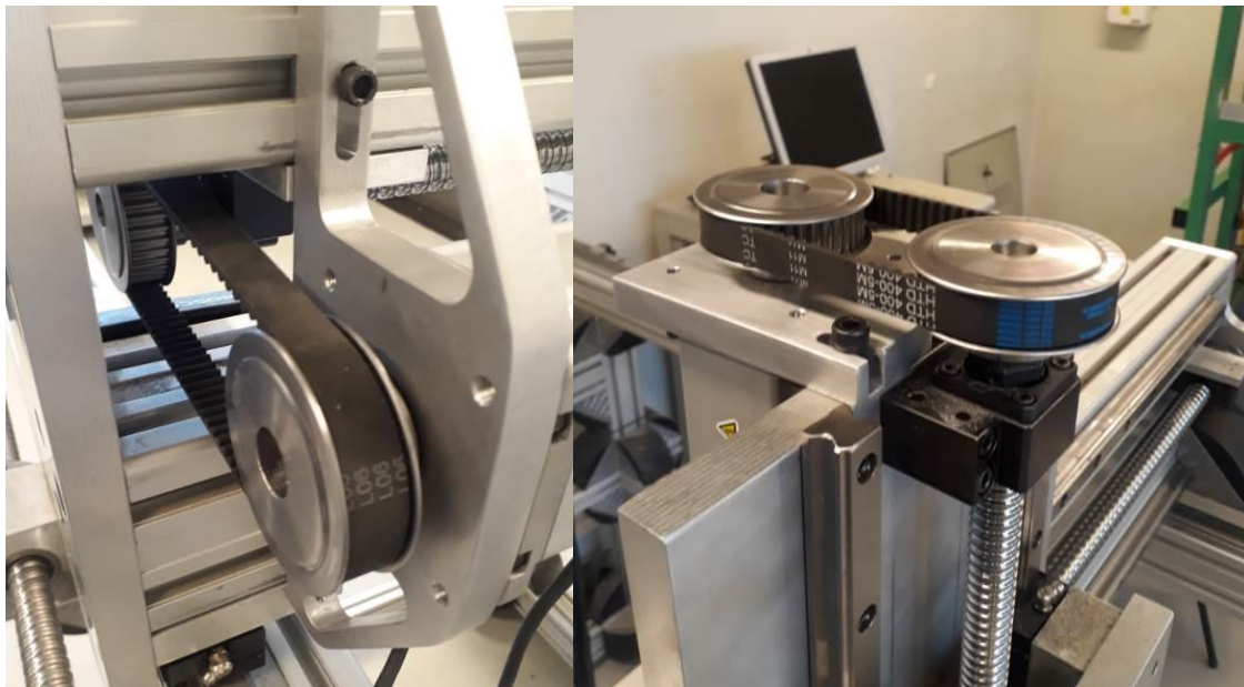
Fig. 8: Soportes de motores con los elementos de transmisión
