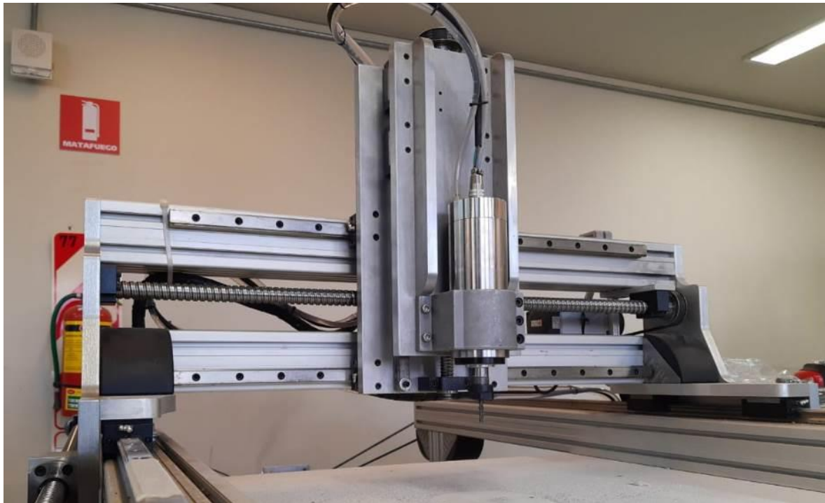
Fig. 11: Cabezal móvil con husillo con conexionado y refrigeración presentados
