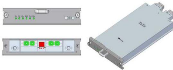
Figura 17: Representación de la vista frontal, posterior y perspectiva del módulo óptico.
