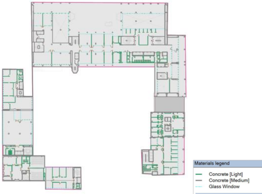
Figura 33: Vista en planta del piso 1 con materiales asignados.
